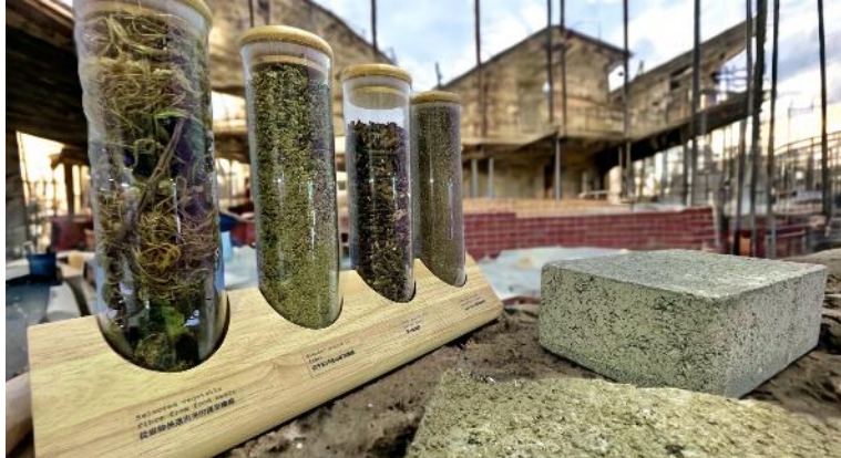
圖四：BSF Innovation 透過開發將廚餘剩食和黑水虻混合的綠色粉末打造「Waste2build」永續環保磚塊，相比傳統建築物料能夠減少六成的溫室氣體排放。
